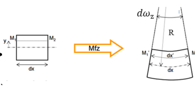
Figure 25 – Tronçon de poutre soumis à la flexion
